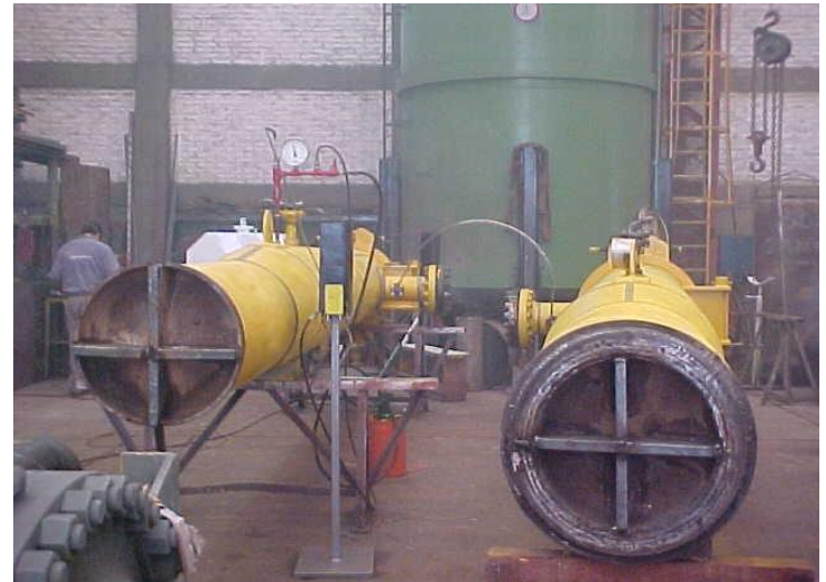
TRAMPAS CRUCE ESTRECHO MAGALLANES RECEPTOR E IMPULSOR 36" x 40" #600
